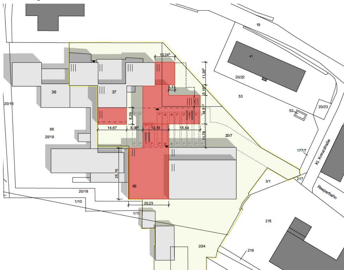
Abbildung 4: Lageplan des Bestands mit der in rot dargestellten Erweiterung (Streich Grage Architekten 06/20)
