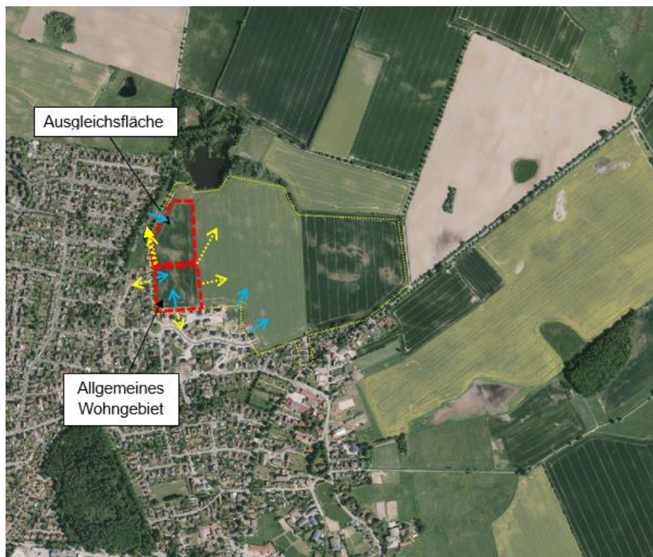
Abb. 3: Flächeninanspruchnahme und Wirkräume der zu erwartenden Wirkfaktoren (Lärm und optische Einflüsse während der Bauphase, Wohnanlage in der Anlage- und Betriebsphase, Pfeillänge entspricht dem Wirkungsbereich).
