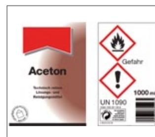
Bild 45 Kennzeichnung von Aceton
