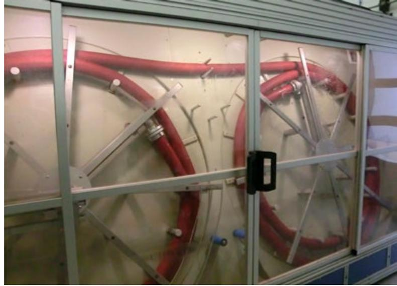
Bild 47 und 48 Kapselung bzw. Abschirmung an der Schlauchwäsche
