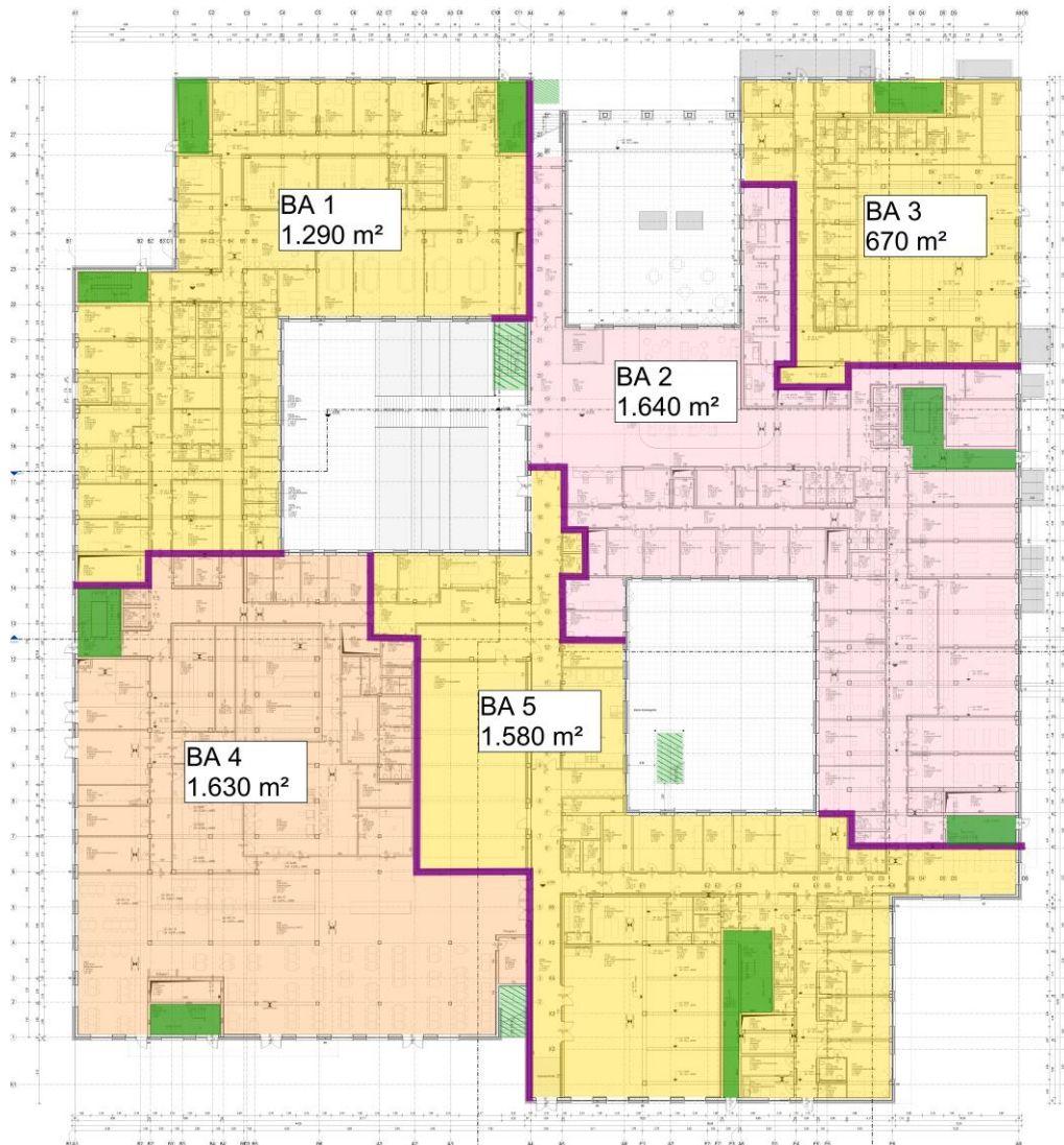
Bild 2: Übersicht Brandabschnitte (Auszug aus der Übersicht im Anhang)
