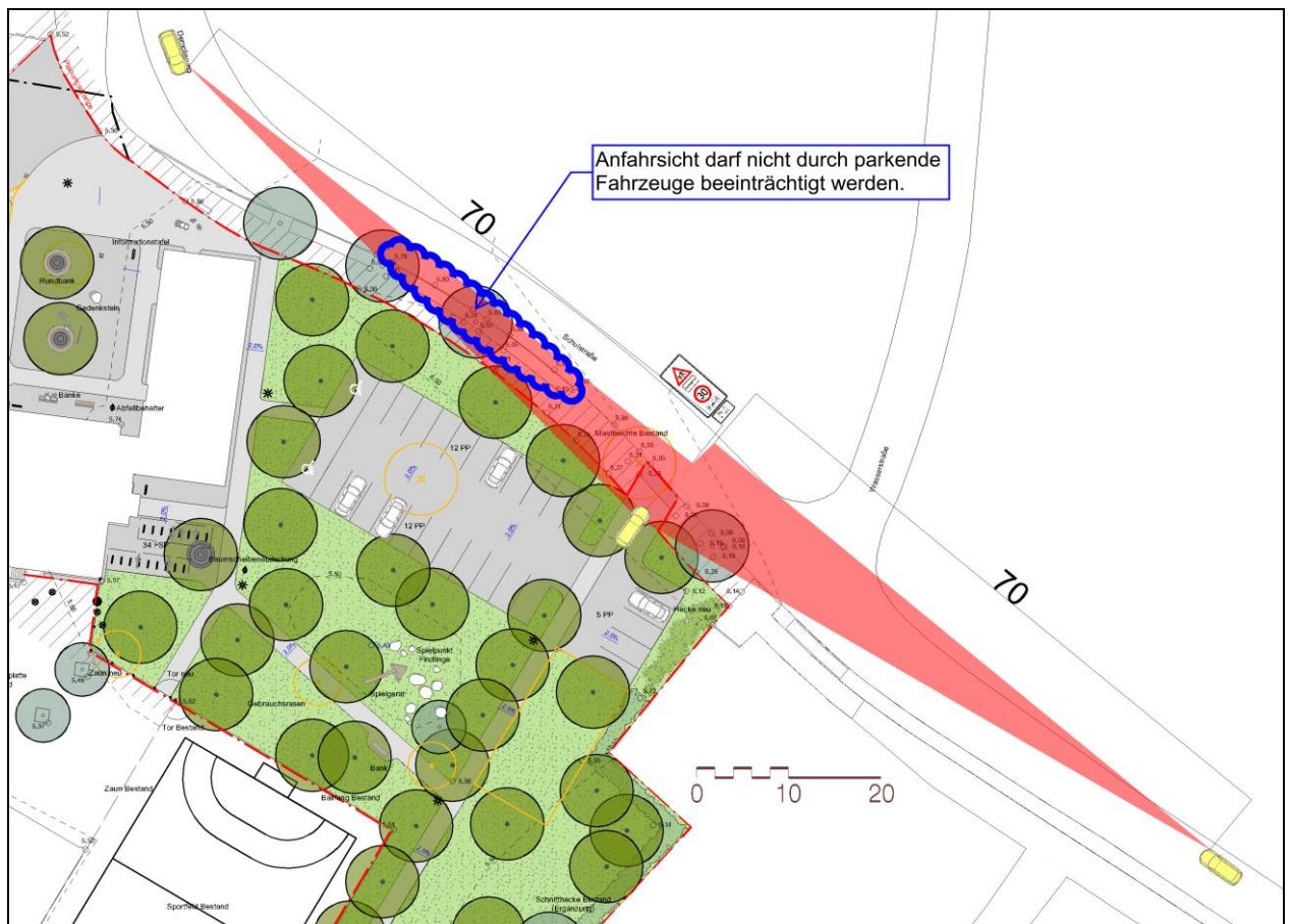
Abb. 43: Anfahrtsicht – Parkierungsanlage Ost
