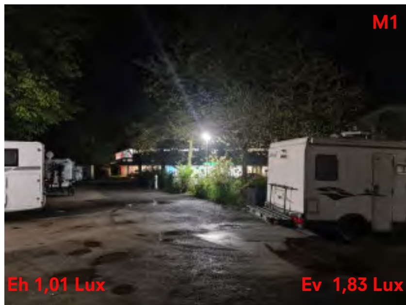
Blickrichtung Schwimmbad Lichtanteil horizontal und vertikal durch Mastleuchten
