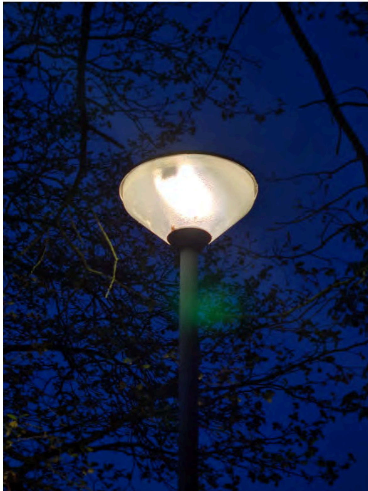
Mastleuchte mit Streuglas und rotationssymmetrischer Abstrahlung Leuchtmittel: Leuchtstoff
