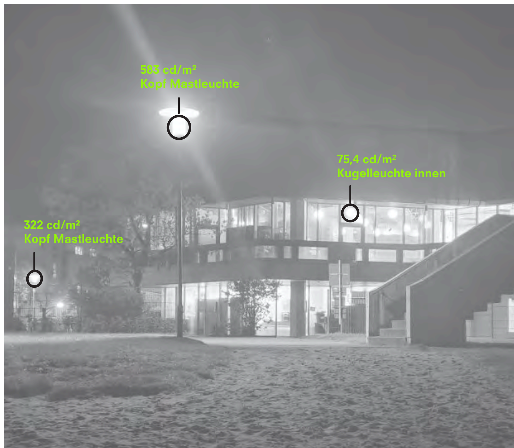
Gemittelte Leuchtdichtewerte; Messwinkel 1° vom Betrachterstandort
