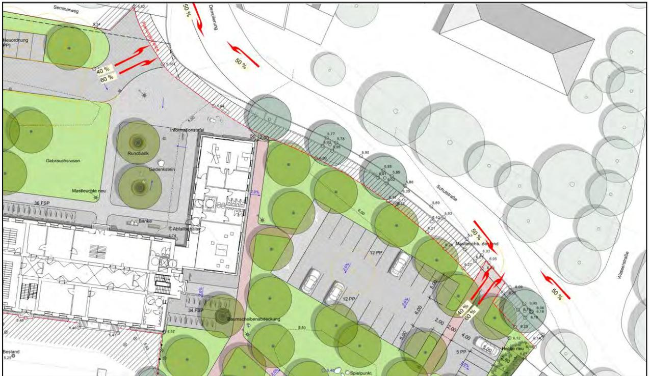
Abb. 23: Zu- und Abflussrouten mit Richtungsverteilung an den Anbindungen
