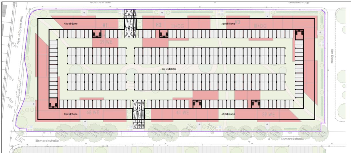
Übersichtsplan Tiefgarage mit Andeutung der darüber liegenden geplanten Baukörper (genordet, ohne Maßstab)
